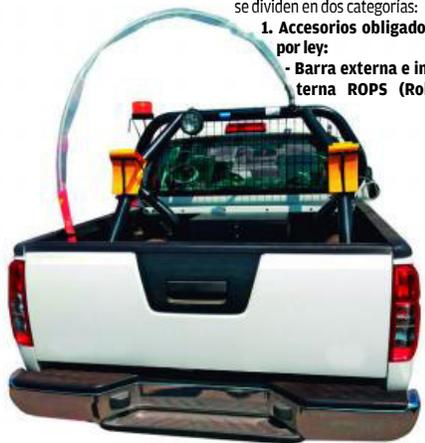
Over Protective Structure): Estructura de protección contra vuelcos, tanto en el exterior como en el interior de la cabina, para proteger a los ocupantes en caso de un vuelco del vehículo.
